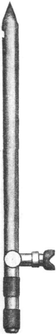
Маленький призмный перископ очень удобен для «потайного» наблюдения за врагом: 1 — объектив; 2 — окуляр.
