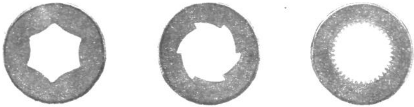
Нарезы старинных «винтовальных» ружей имели разнообразную форму. Вот некоторые из них.
